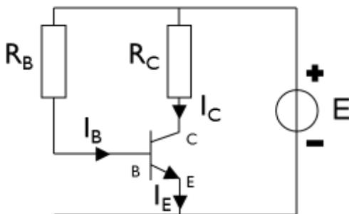
Soit le montage ci-contre : le transistor est utilisé en amplificateur de courant.
