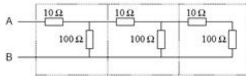
En déduire la résistance équivalente  $R_3$  vue des bornes A et B.
