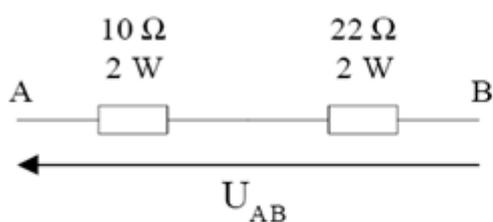
Calculer la tension  $U_{AB}$  maximale que peut supporter le circuit.
